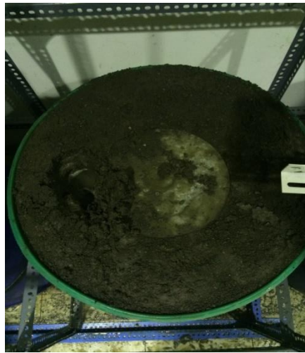
Gambar 3.15 Hasil pengujian loading test
