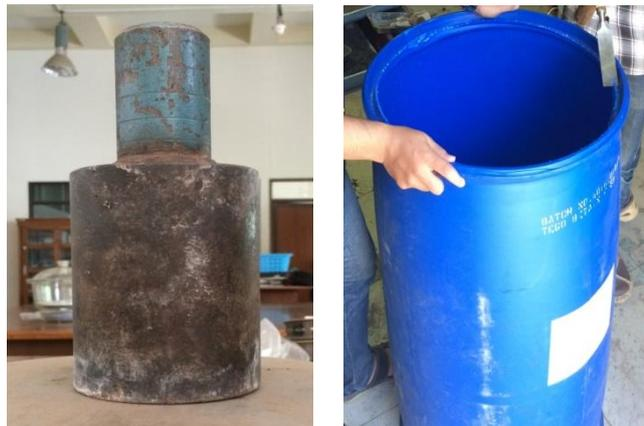
Gambar 3.4 Drum uji sebagai silinder benda uji dan penumbuk
