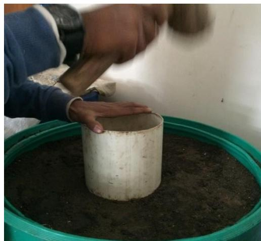
Gambar 3.13 Pengeboran pembuatan kepala kolom *T-shape* 70 cm
