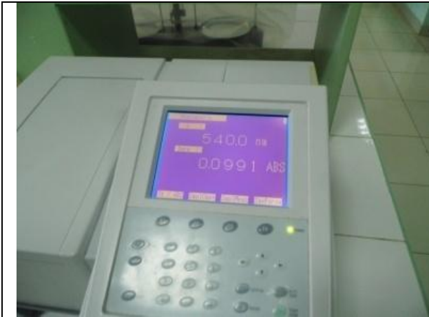
k. Peneraan dengan Spectrofotometer
