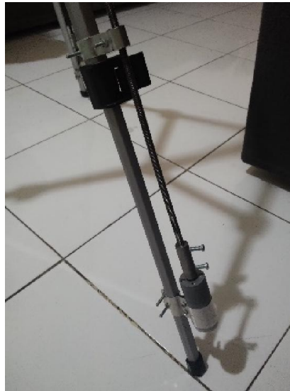
Gambar 3.17 Pemasangan Motor DC di Kaki Tripod
