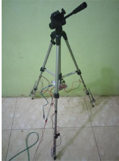
**Gambar 4.1** Bentuk Fisik Sistem *Self-Leveling* Tripod
