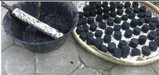
Briket yang sudah dicetak dan dikempa
