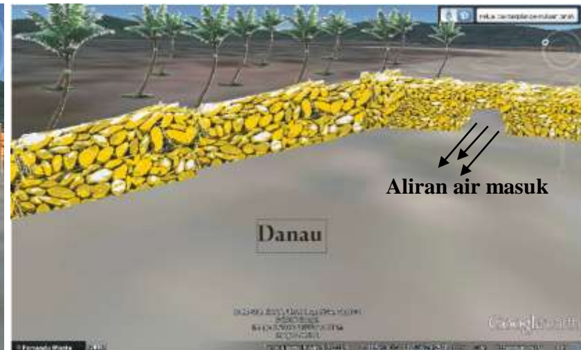
Gambar 18. Kawat bronjong dan jalan masuk air dari muara ke danau
