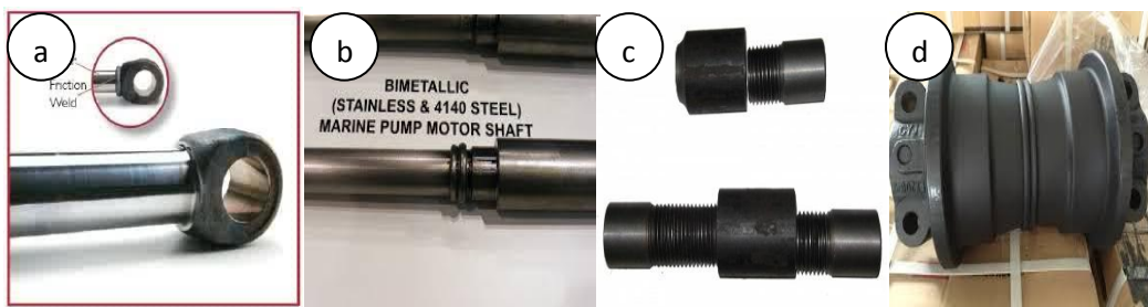
Gambar 2.6. Aplikasi pengelasan gesek metode rotary. a). Hydraulic cylinder piston , b). Pump motor shaft , c). shaft dan d). cylinder
