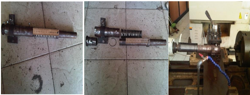
Gambar 3.2. Alat yang digunakan sebagai las gesek pipa tembaga dan kuningan ukuran 5/8”
