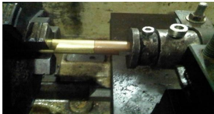
Gambar 3.9. Pemasangan bahan diposisikan center.
