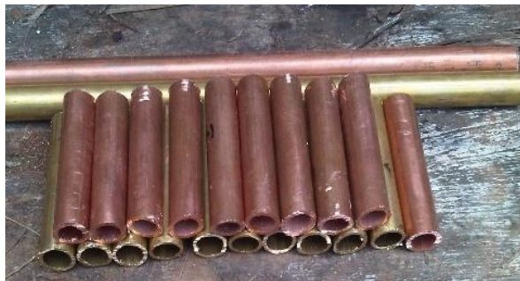
Gambar 3.7. Pemotongan bahan pipa tembaga dan kuningan.
