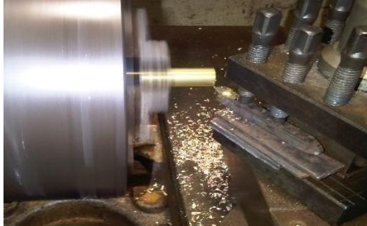
Gambar 3.8. Meratakan ujung bahan pipa tembaga dan kuningan dengan mesin bubut.
