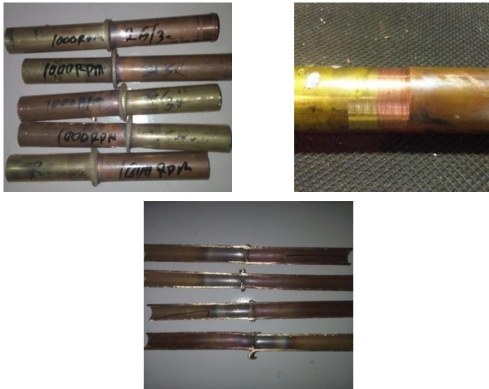
Gambar 4.1. Proses penyiapan benda uji setelah pengelasan dan siap untuk di uji struktur mikro dan kekerasan.
