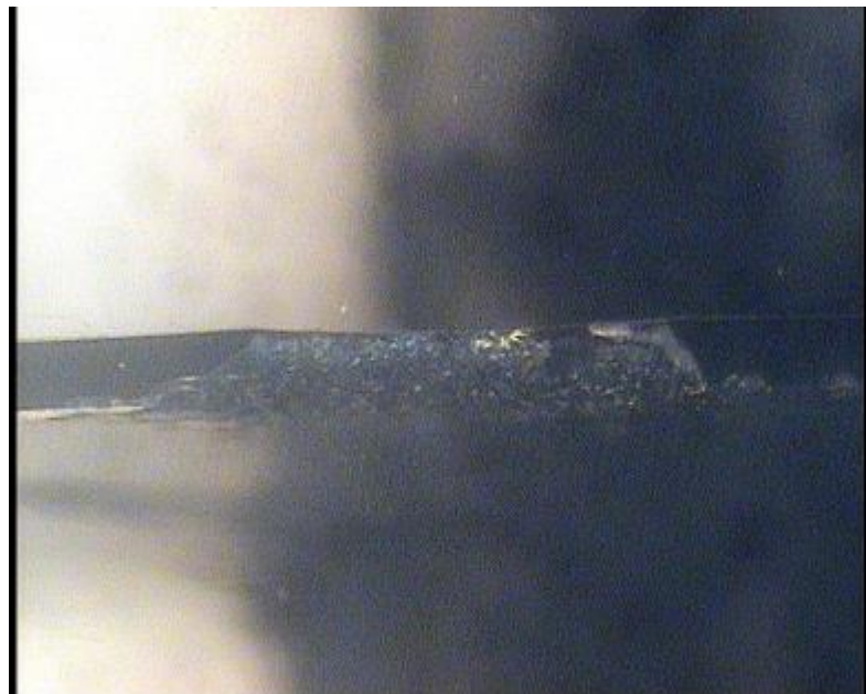
Lampiran 11. Foto makro ketirusan benda kerja dengan gap 0,75 mm, tegangan 10 volt dan waktu pemesinan 248 detik
