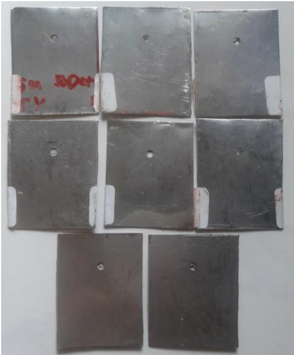
Lampiran 4. Benda kerja hasil pemesinan yang gagal tampak depan
