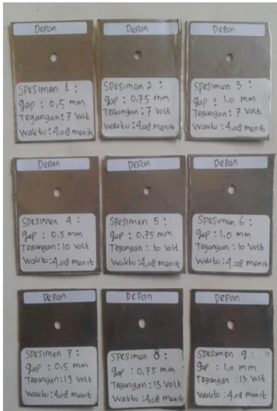
Lampiran 2. Benda kerja hasil pemesinan yang berhasil tampak depan
