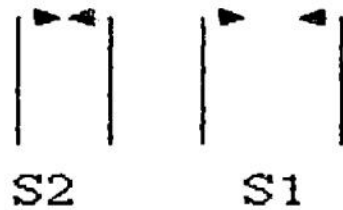
Gambar 2.18. Relay Dengan Dua Saklar Kontak S1 Normal Terbuka S2 Normal Tertutup (Sumber : Santosa, 1996)
