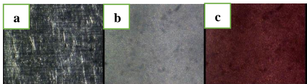
Gambar 5. Foto makro variasi kuat arus 1 Ampere, (a). Raw material, (b). Setelah proses anodizing , (c). Setelah proses dyeing .
