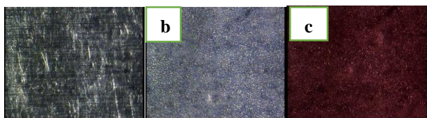
Gambar 6. Foto makro variasi kuat arus 2 Ampere, (a). Raw material, (b). Setelah proses anodizing , (c). Setelah proses dyeing .
