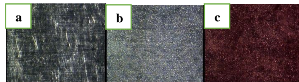
Gambar 7. Foto makro variasi kuat arus 3 Ampere, (a). Raw material, (b). Setelah proses anodizing , (c). Setelah proses dyeing .
