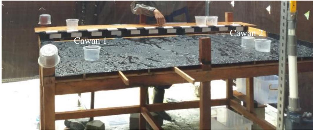
Gambar 4.19 letak cawan pada alat uji *street inlet*
