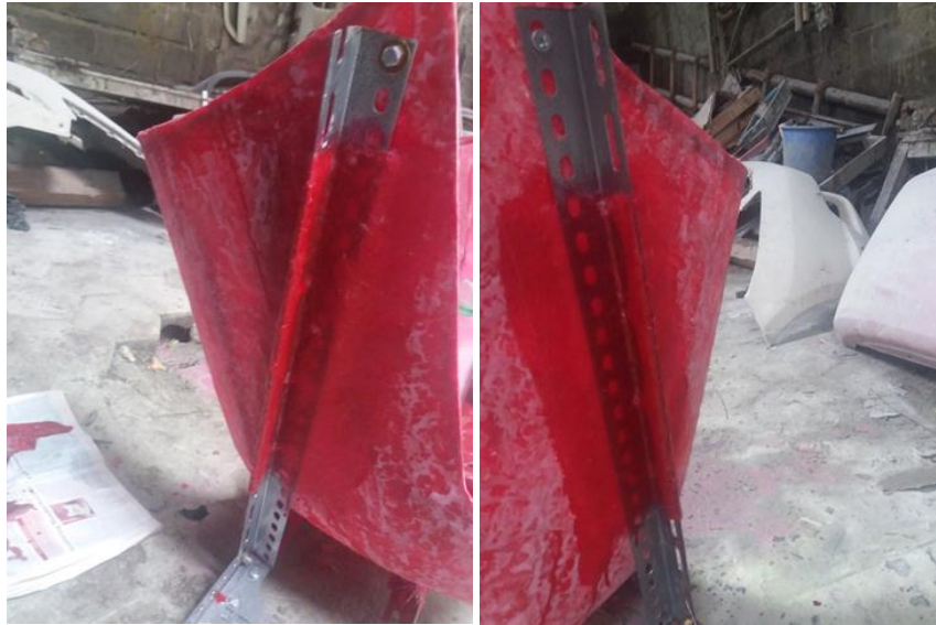
Gambar 4.34. Pemasangan besi dudukan pada bagian sanping moulding .
