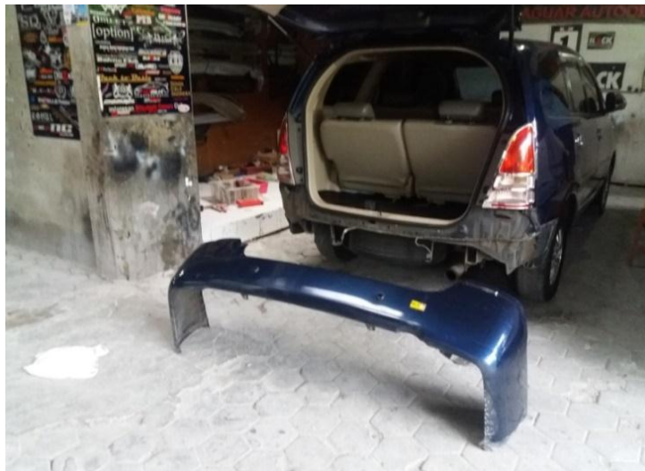
Gambar 4.4. Bumper yang sudah dilepas dan di bersihkan.
