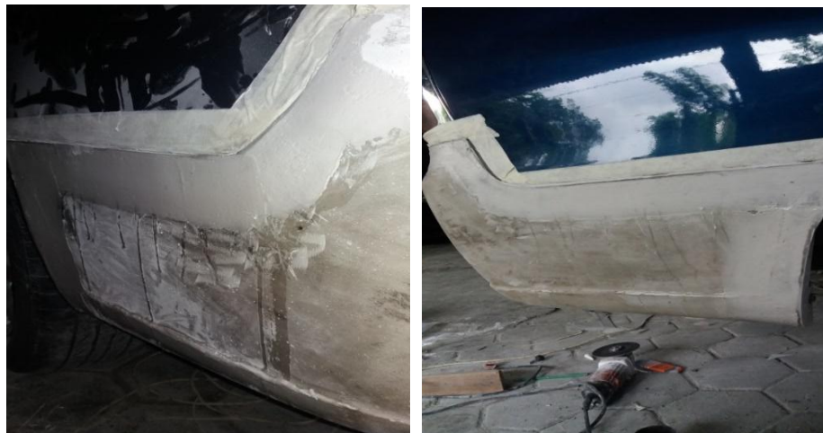
Gambar 4.15. Hasil akhir pengecoran dempul fiberglass .
