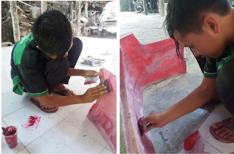
Gambar 4.31. Pendempulan void pada moulding menggunakan gealcoat .
