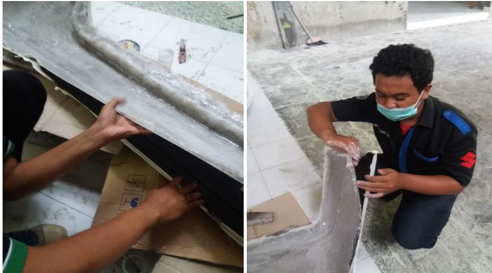
Gambar 4.10. Pelepasan cetakan (produk) pada master .
