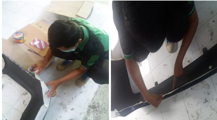
Gambar 4.6. Pemasangan selotip kertas pada master .
