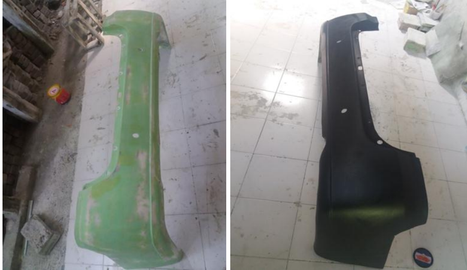
Gambar 4.23. hasil akhir finishing awal pengampelasan dan epoxy.
