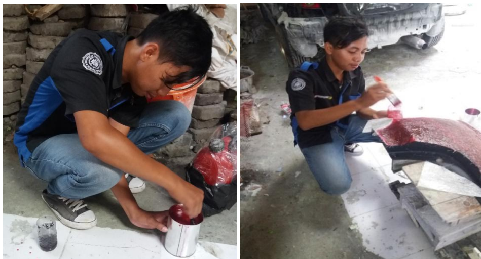
Gambar 4.25. Pencampuran gelcoat dan 1 pelapisan pada produk bumper.
