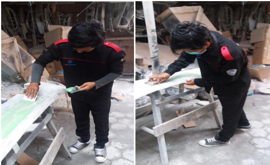
Gambar 4.22. pendempulan dan pengampelasan.
