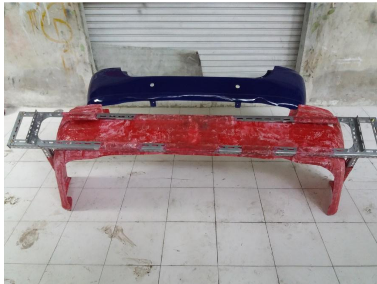
Gambar 4.35. Hasil akhir dari pencetakan produk bumper dan moulding .
