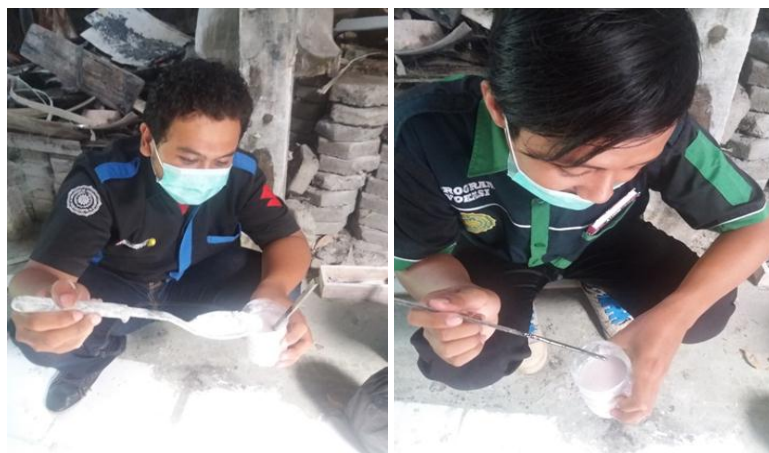
Gambar 4.7. Pencampuran resin + hardener + talc .
