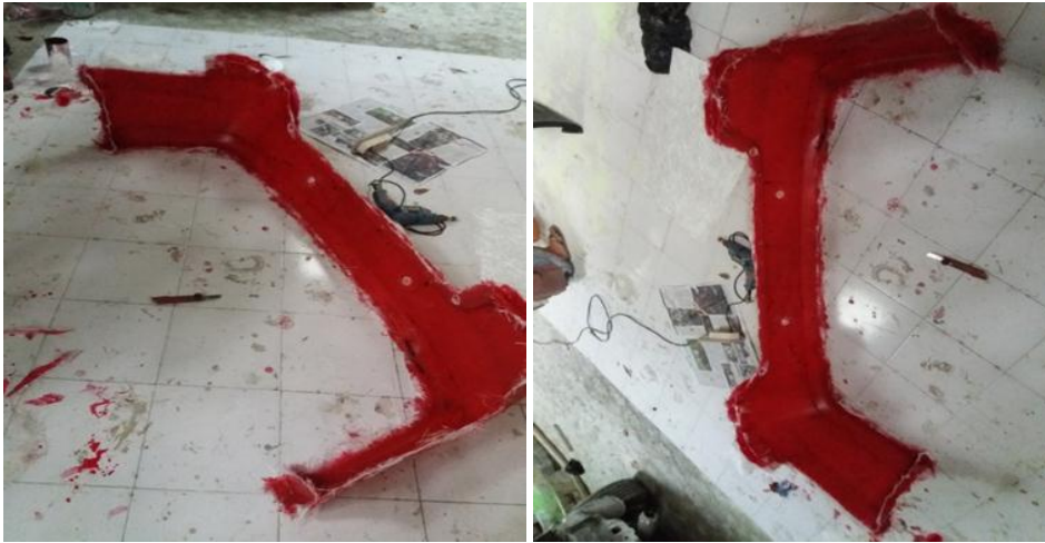
Gambar 4.28. Hasil dari cetakan 1 lapisan mat.
