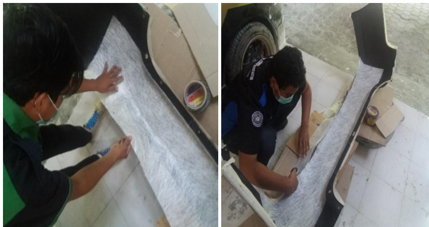
Gambar .4.8. pemasangan dan pengukuran mat (serat).
