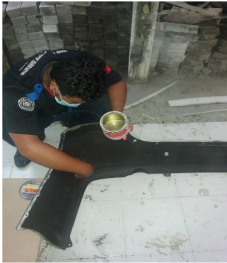
Gambar 4.5. Pelapisan MAA pada master .
