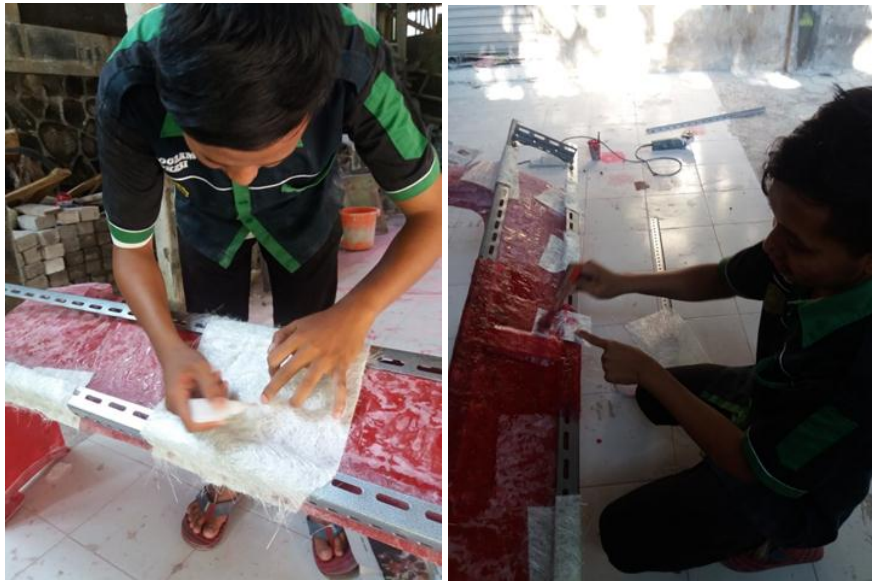
Gambar 4.33 Pemasangan besi dudukan pada moulding .
