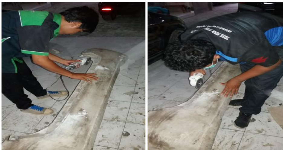
Gambar 4.11. Pembersihan sirip sirip bumper (produk).
