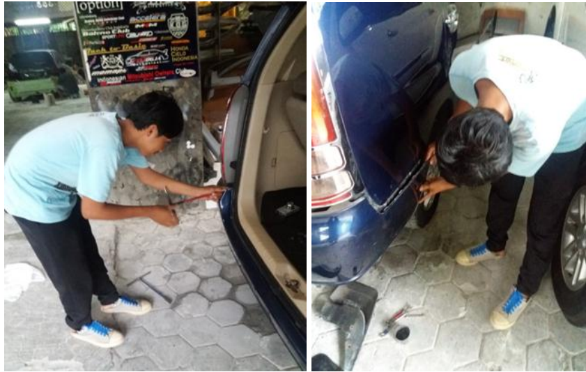
Gambar 4.3. Pelepasan bumper di kendaraan.
