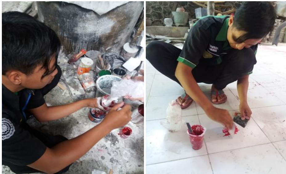
Gambar 4.30. Pencampuran resin, talc , hardener , dan pigment.
