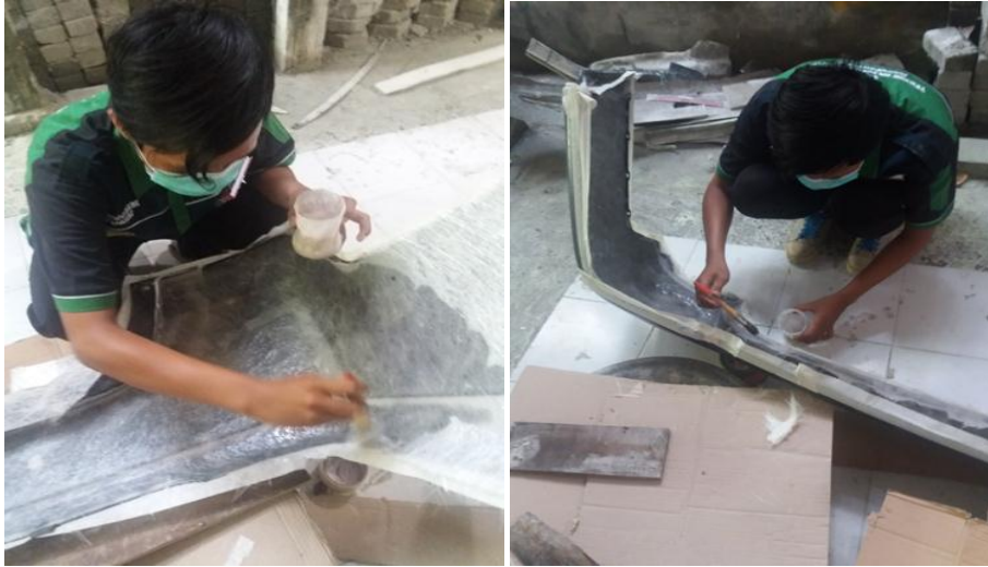
Gambar 4.9. Proses pencetakan menggunakan metode/teknik Hand Lay-Up (HLU).
