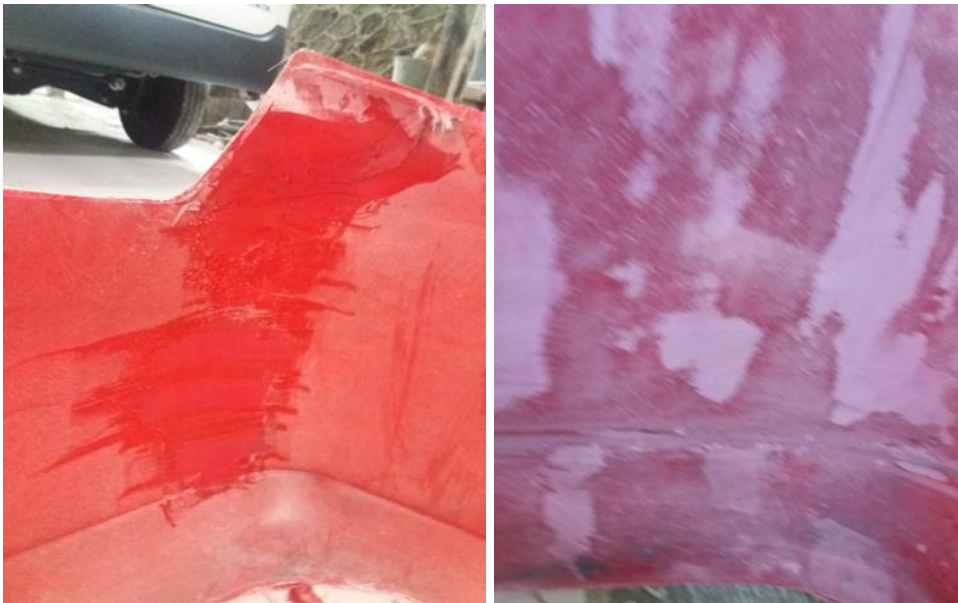
Gambar 4.32 Hasil pendempulan gealcoat .
