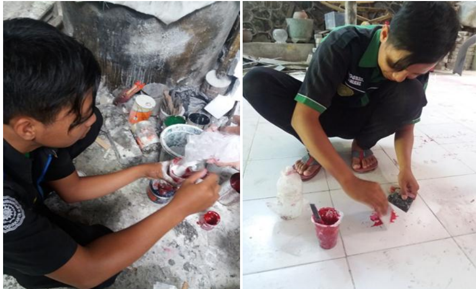
Gambar 4.30. Pencampuran resin, talca , hardener , dan pigment.
