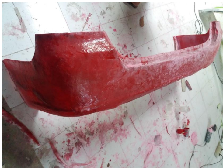
Gambar hasil pembuatan moulding dari tampak depan moulding
