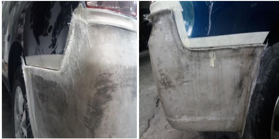
Gambar 4.14. pengecoran fiberglass hasil pengukuran.
