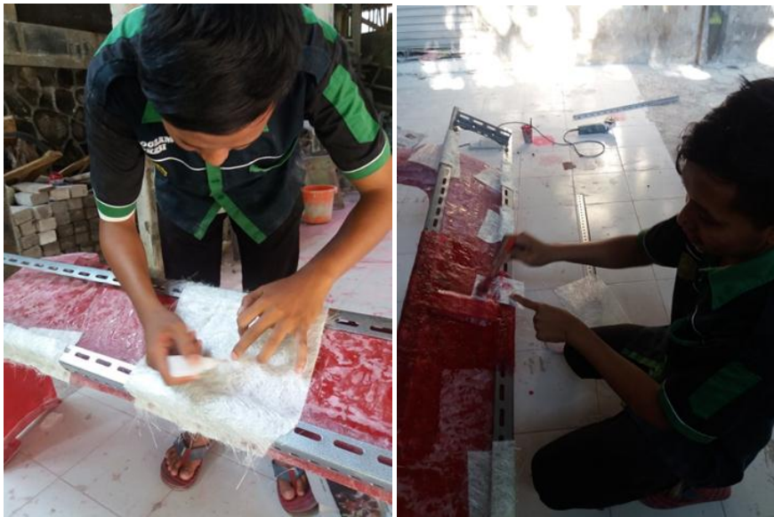
Gambar 4.33 Pemasangan besi dudukan pada moulding .
