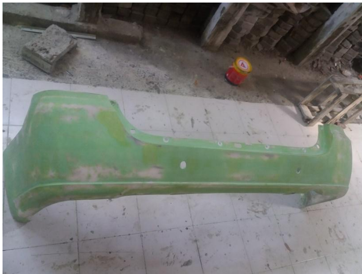
Gambar hasil akhir pendempulan dan pengamplasan.
