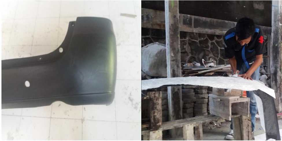
Gambar 4.24. Pegolesan MAA pada produk dan pengukuran serat (mat) pada produk bumper.
