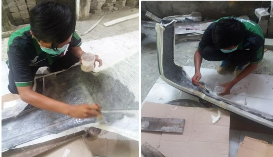
Gambar 4.9. Proses pencetakan menggunakan metode/teknik Hand Lay-Up (HLU).
