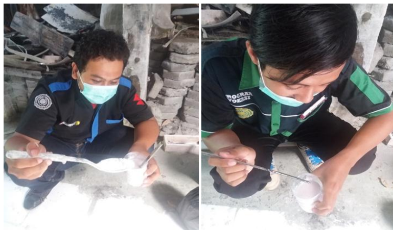
Gambar 4.7. Pencampuran resin + hardener + talc .
