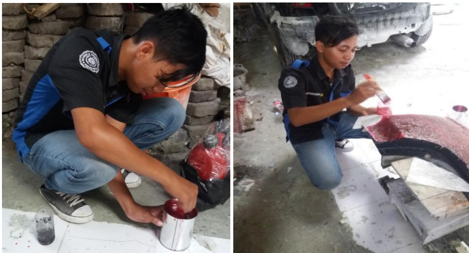
Gambar 4.25. Pencampuran gealcoat dan 1 pelapisan pada produk bumper.
