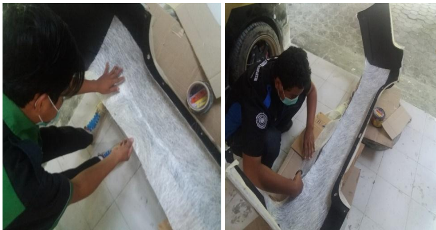
Gambar .4.8. pemasangan dan pengukuran mat (serat).
