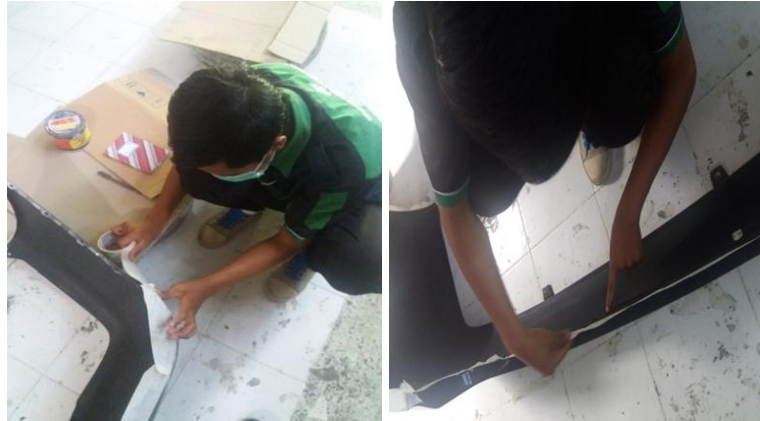
Gambar 4.6. Pemasangan selotip kertas pada master .
