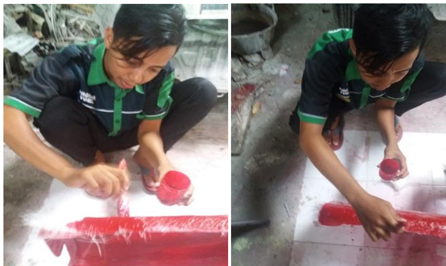
Gambar 4.27. Pelapisan mat yang ke 2 dan ke 3 pada moulding .
