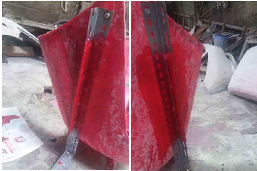
Gambar 4.34. Pemasangan besi dudukan pada bagian samping moulding .
