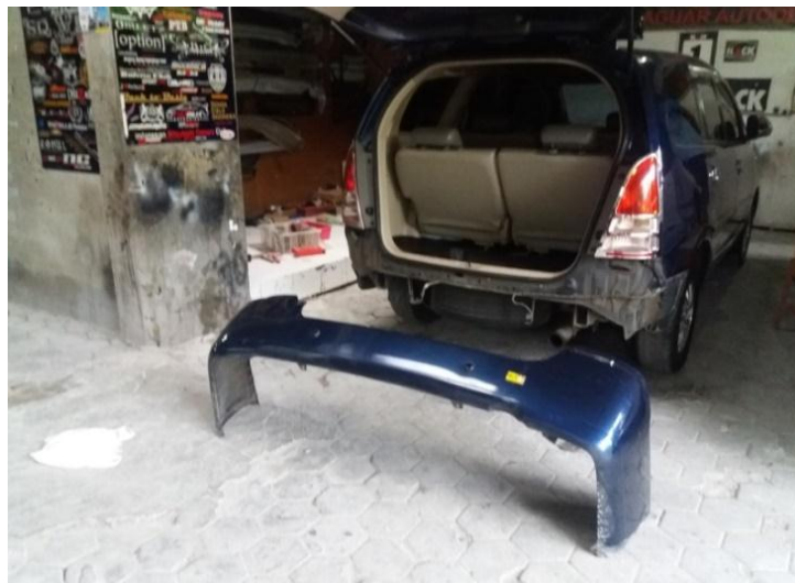
Gambar 4.4. Bumper yang sudah dilepas dan di bersihkan.
