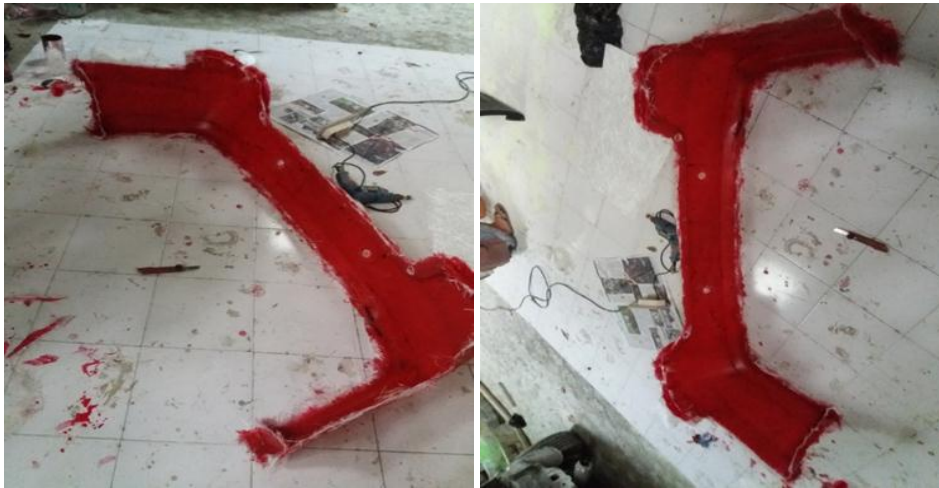
Gambar 4.28. Hasil dari cetakan 1 lapisan mat.
