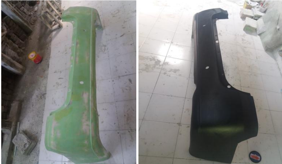
Gambar 4.23. hasil akhir finishing awal pengampelasan dan epoxy.
