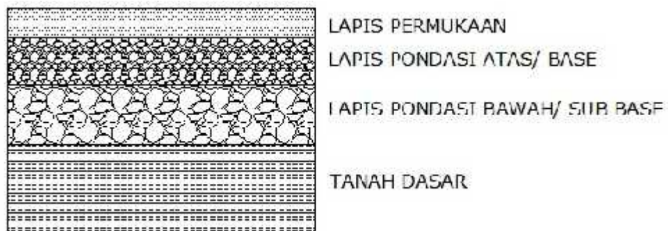
Gambar 2.1. Susunan perkerasan lentur.
