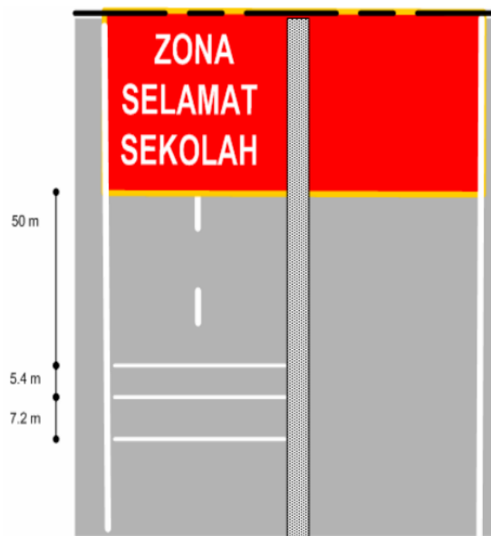
Gambar 3.5 Pemasangan Pita Penggaduh Pada Zona Selamat Sekolah
