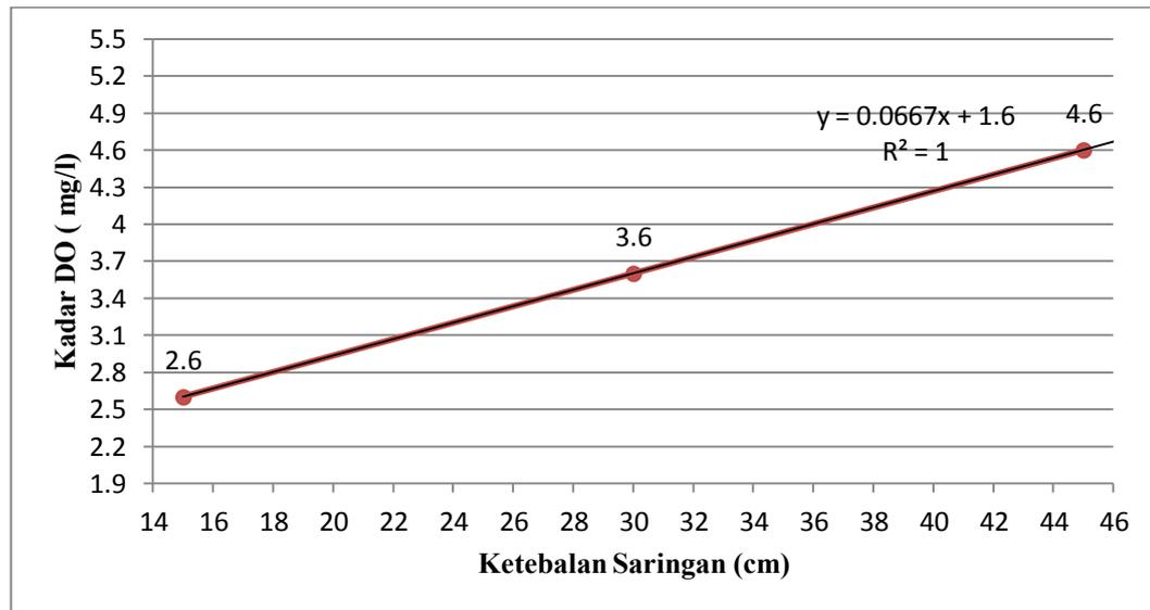
Gambar 5.3 Hasil Pengujian Kadar DO Zeolit
