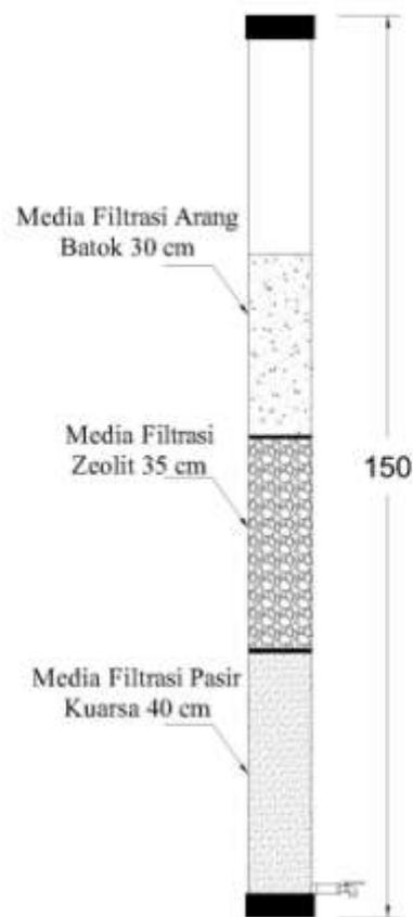
Gambar 5.9 Alat Filtrasi yang Digunakan
