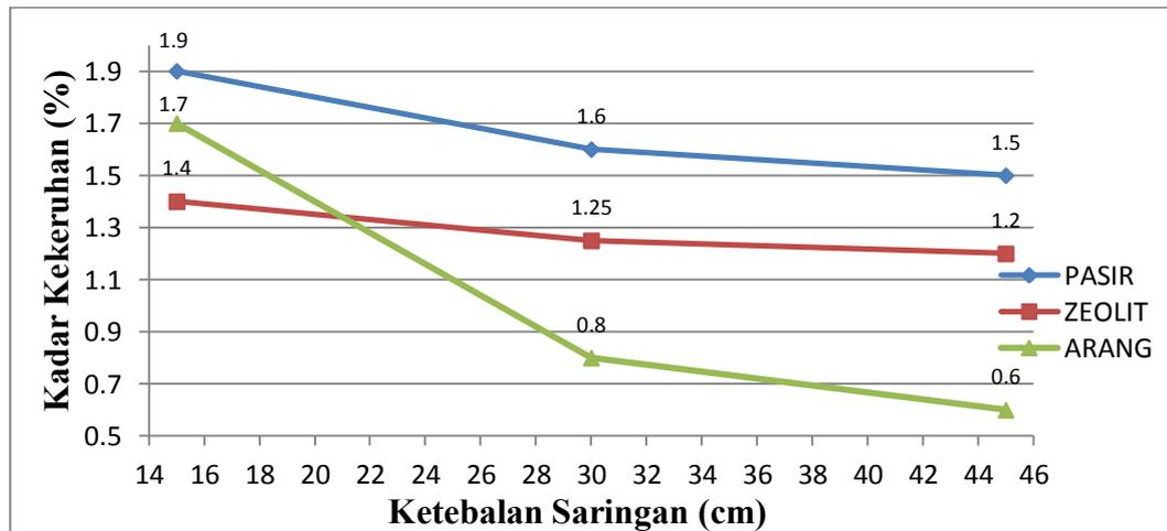
Gambar 5.5 Hasil Pengujian Kadar Kekeruhan Pasir, Zeolit, dan Arang Batok
