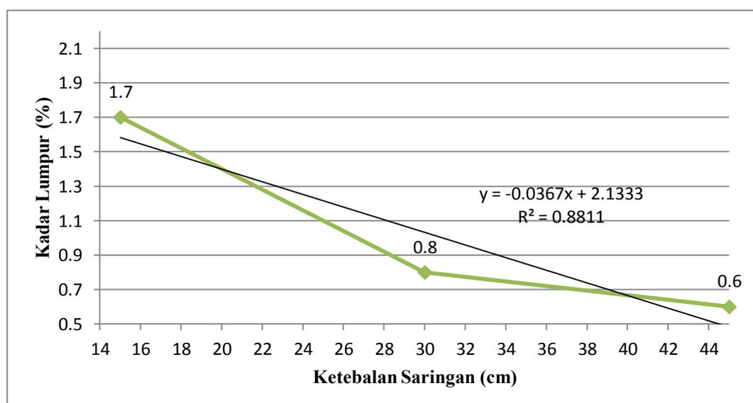
Gambar 5.8 Hasil Pengujian Kadar Kekeruhan Arang Batok
