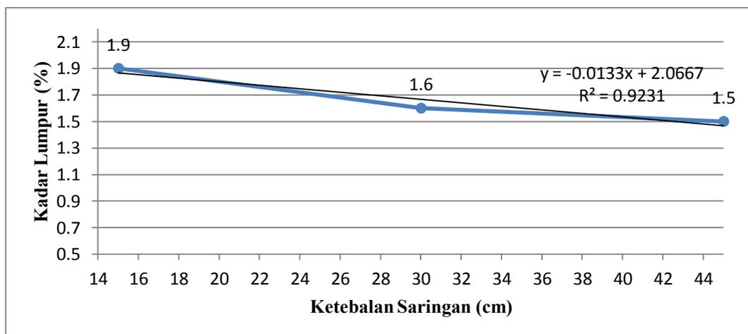
Gambar 5.6 Hasil Pengujian Kadar Kekeruhan Pasir
