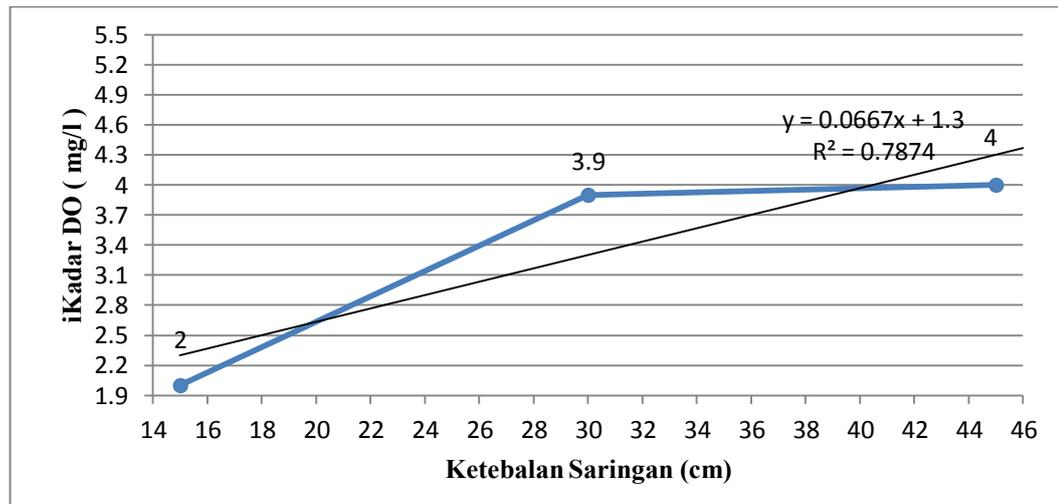
Gambar 5.2 Hasil Pengujian Kadar DO Pasir
