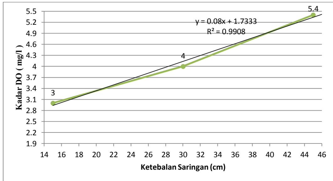
Gambar 5.4 Hasil Pengujian Kadar DO Arang Batok
