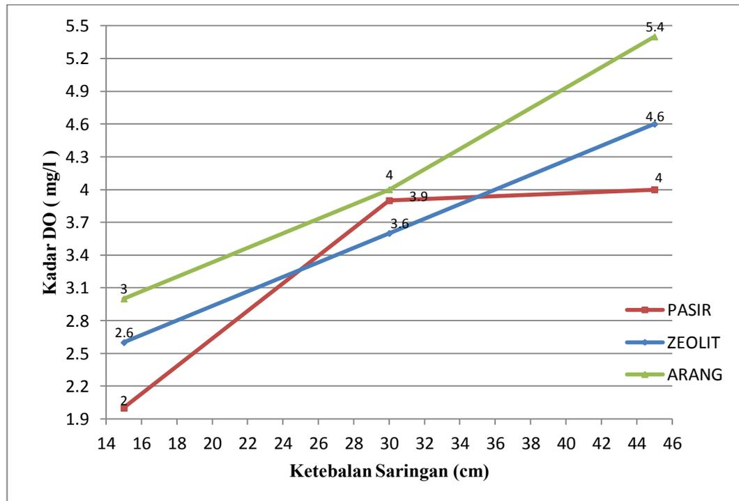
Gambar 5.1 Hasil Pengujian Kadar DO Pasir, Zeolit, dan Arang
