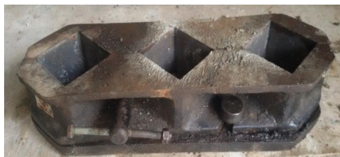
Gambar 4.8 Cetakan mortar 5cm x 5 cm x 5cm
