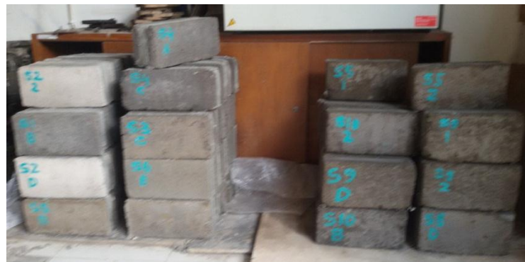
Gambar 4.3 Bata beton / batako pejal
