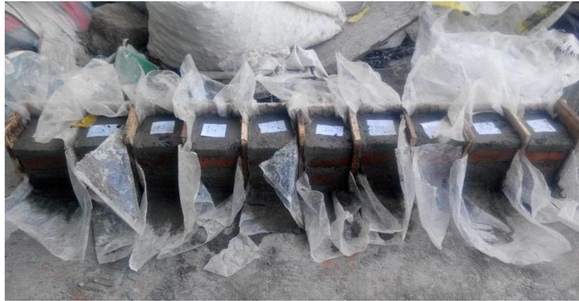
Gambar 4.11 Pasangan batu bata dengan mortar
