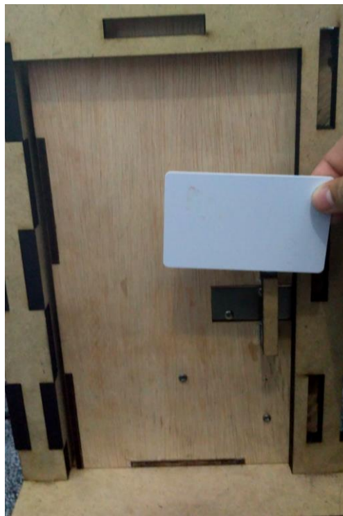
Gambar 4.1 Reader membaca ID sebuah tag NFC
