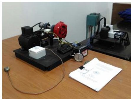
Gambar 3.21. Alat Uji Percikan Bunga Api Busi
