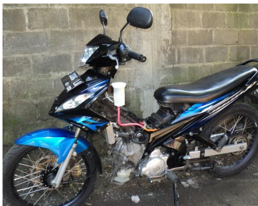
Gambar 3.23. Pengujian Konsumsi Bahan Bakar
