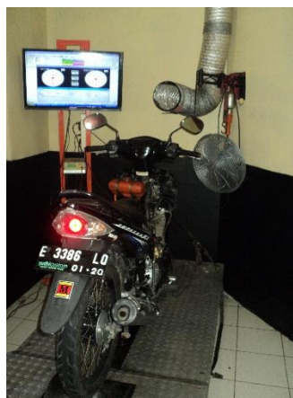
Gambar 3.22. Pengujian Kinerja Mesin
