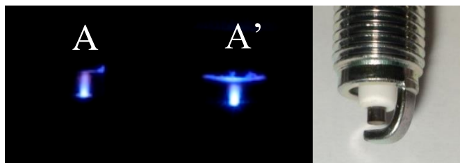
Gambar 4.3. Percikan Bunga Api Busi dengan Menggunakan Koil Standar (A), Koil KTC Racing (A'), dan Busi NGK Standar
