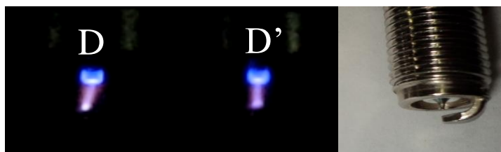
Gambar 4.6. Percikan Bunga Api Busi dengan Menggunakan Koil Standar (D), Koil KTC Racing (D'), dan Busi Denso Iridium
