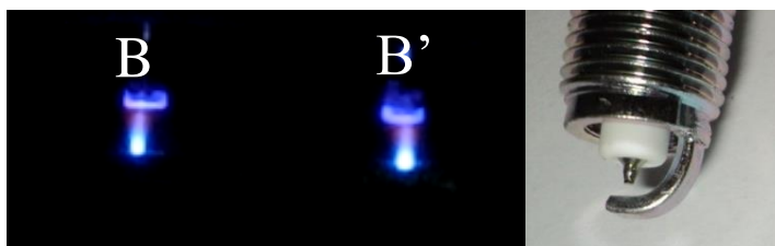
Gambar 4.4. Percikan Bunga Api Busi dengan Menggunakan Koil Standar (B), Koil KTC Racing (B'), dan Busi NGK G-Power
