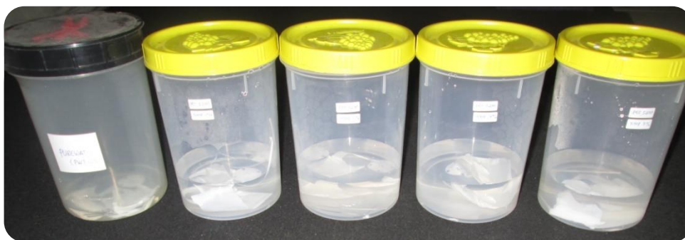
Gambar 3.17. Media Gelatinisasi dengan variasi NMP 0 %, 1%, 3%, 5%, 7% (berurutan dari kiri ke kanan)
