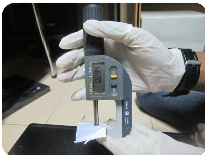
Gambar 3.20. Proses pengukuran ketebalan membran PES
