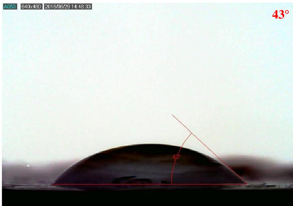
Gambar 4.16 Pengamatan *Water Contact Angle* pada media gelatinisasi NMP 7 %
