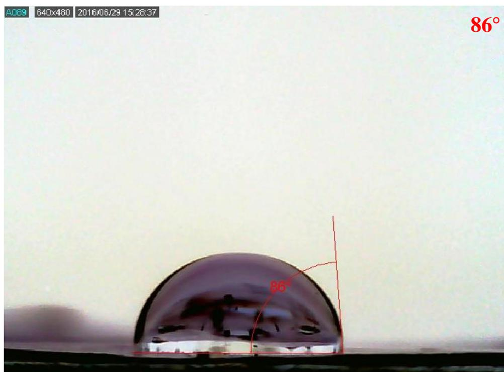
Gambar 4.12. Pengamatan *Water Contact Angle* pada media gelatinisasi NMP 0 %
