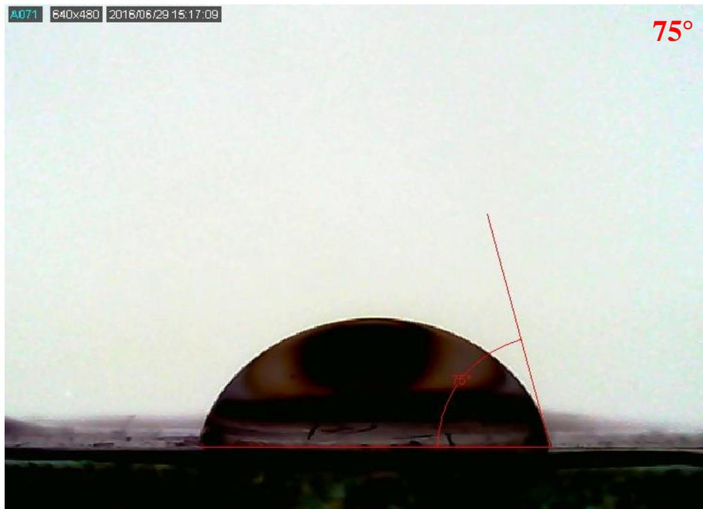
Gambar 4.13. Pengamatan *Water Contact Angle* pada media gelatinisasi NMP 1 %
