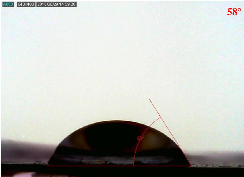
Gambar 4.15 Pengamatan *Water Contact Angle* pada media gelatinisasi NMP 5 %
