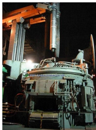
Gambar 2.5 Mesin busur listrik skala industri tidak beroperasi
