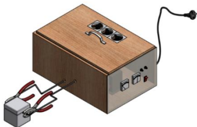
Gambar 14 Proses Peleburan Menggunakan Busur Listrik
