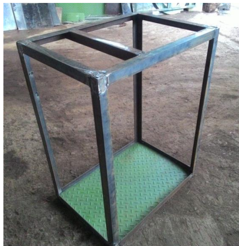
Gambar 4.7 Hasil akhir pemasangan alas incinerator
