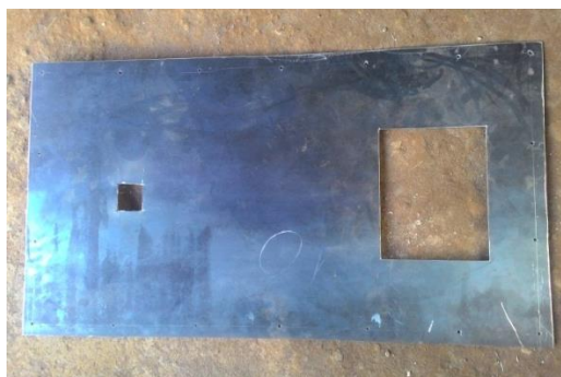
Gambar 4.13 Hasil pembuatan casing belakang incinerator
