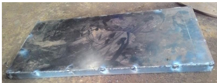
Gambar 4.23 Hasil pemasangan plat pada rangka pintu
