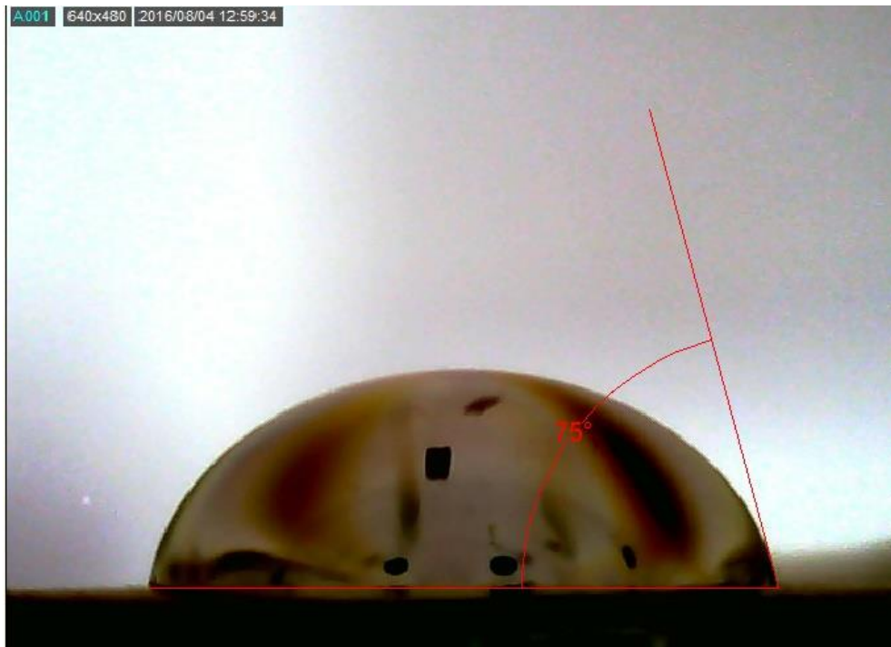
Gambar 4. 14. Water contact angle yang terbentuk pada membran dengan variasi media gelatin NMP 2%
