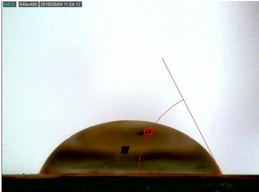
Gambar 4. 16. Water contact angle yang terbentuk pada membran dengan variasi media gelatin NMP 6%
