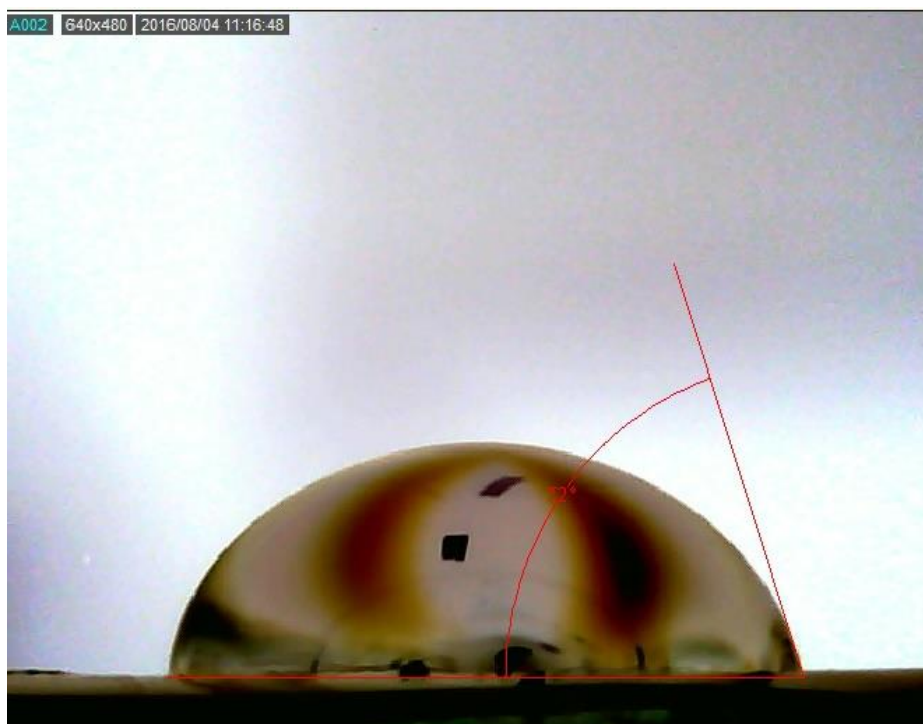
Gambar 4. 13. Water contact angle yang terbentuk pada membran dengan variasi media gelatin Akuades
