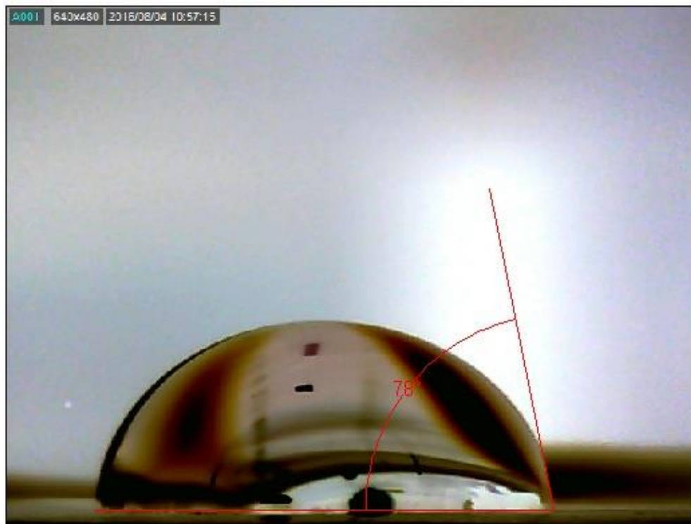
Gambar 4. 15. Water contact angle yang terbentuk pada membran dengan variasi media gelatin NMP 4%
