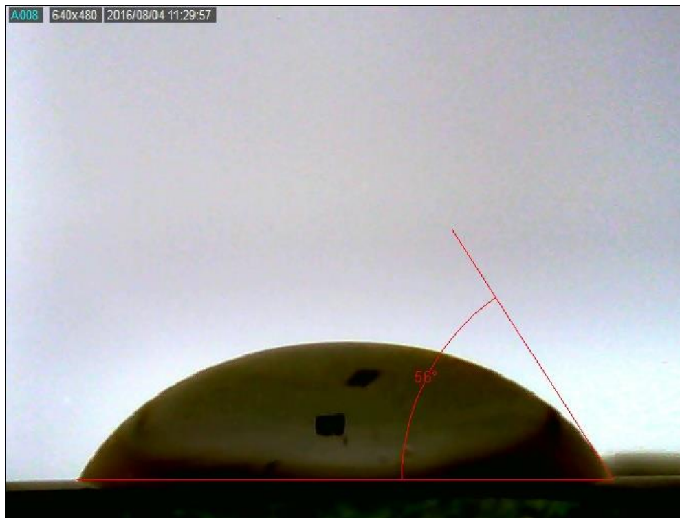
Gambar 4. 17. Water contact angle yang terbentuk pada membran dengan variasi media gelatin NMP 8%
