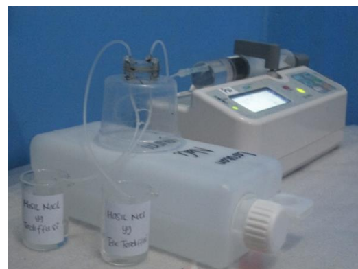
Gambar 3. 19. Pengujian tes difusi menggunakan satu syringe pump untuk menentukan nilai water flux
