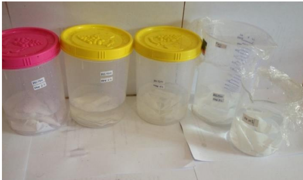
Gambar 3. 6. Media gelatinasi dengan variasi NMP 2%, 4%, 6%, 8%, dan 100% akuades
