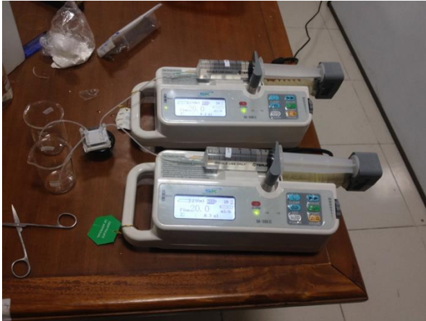
Gambar 2. 11. Pengujian difusi tes menggunakan dua syringe pumps untuk menentukan nilai koefisien difusinya
