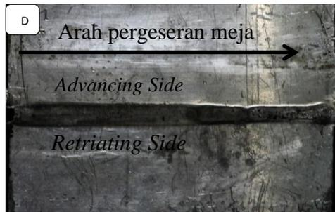
Gambar 4 hasil pengelasan dengan metode FSW variasi kecepatan putar *tool* dengan *feed rate* 20 mm/menit (a) 1300 rpm, (b) 2200 rpm, (c) 3300 rpm dan (d) tampak bagian bawah lasan
