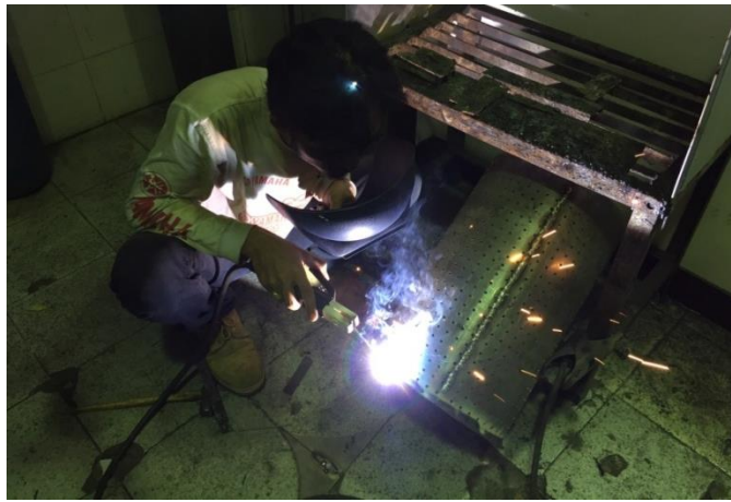
Gambar 4.8. Proses pembuatan tabung mesin
