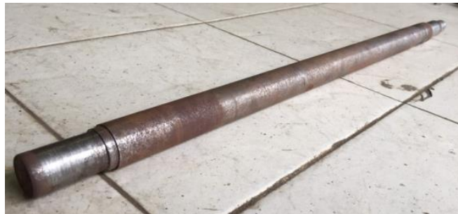
Gambar 4.24. Poros tabung mesin penyangrai kopi
