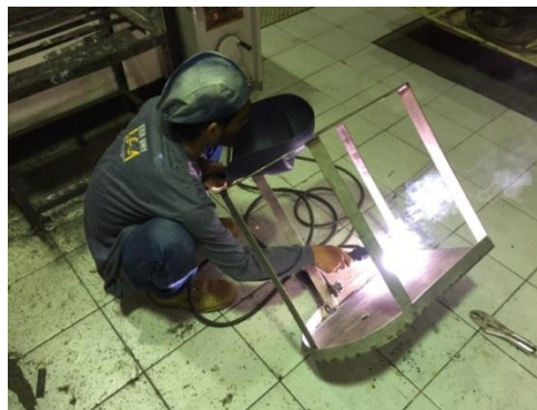
Gambar 4.16. Proses pembuatan kerangka tabung
