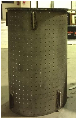
Gambar 4.9. Tabung dalam mesin penyangrai kopi
