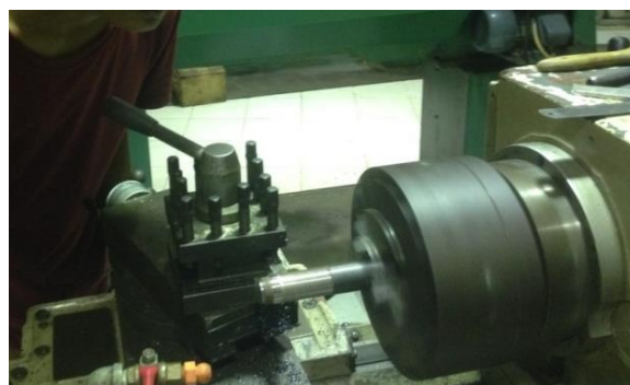
Gambar 4.29. Proses pembuatan poros cooling
