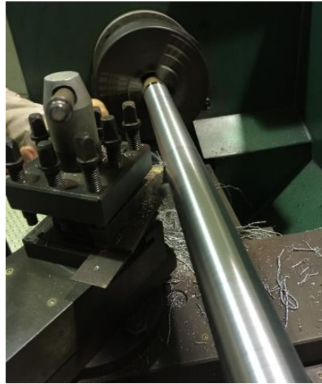
Gambar 4.23. Proses pembuatan poros tabung
