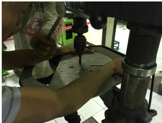
Gambar 4.20. Proses pembuatan tutup tabung utama
