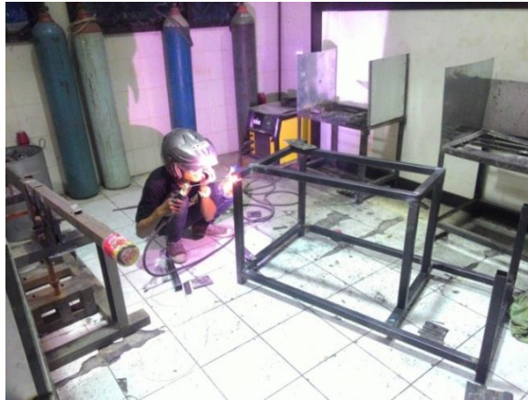
Gambar 4.3. Proses pembuatan rangka mesin penyangrai kopi
