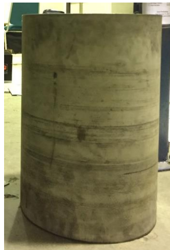
Gambar 4.12. Tabung luar mesin penyangrai kopi
