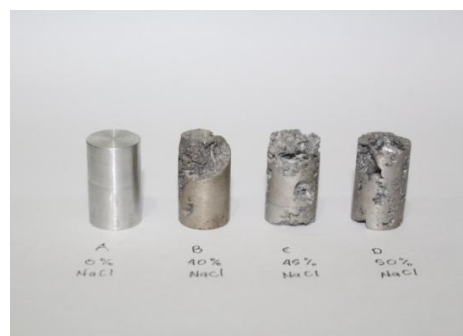
Gambar 3. Spesimen aluminum foam setelah proses pemesinan
