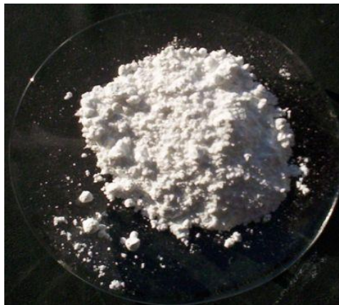
Gambar 2.21. Serbuk Kalsium Karbonat sebagai blowing agent (PT. Kalsitech Prima, Surabaya, 2015).
