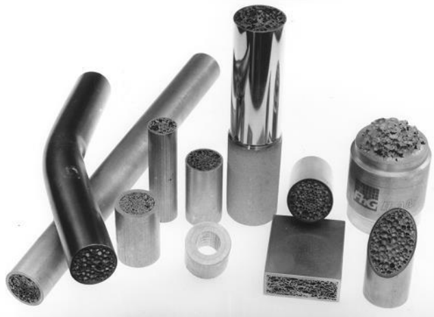
Gambar 2.5. Macam-Macam Rangka Mobil dengan Metal Foam (Kammer, 1999).
