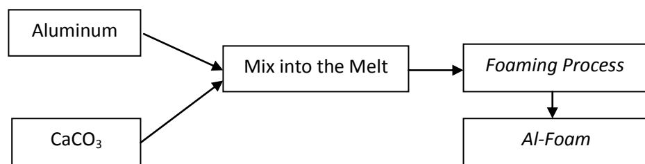
Gambar 3.12. Diagram proses pembuatan Aluminum Foam
