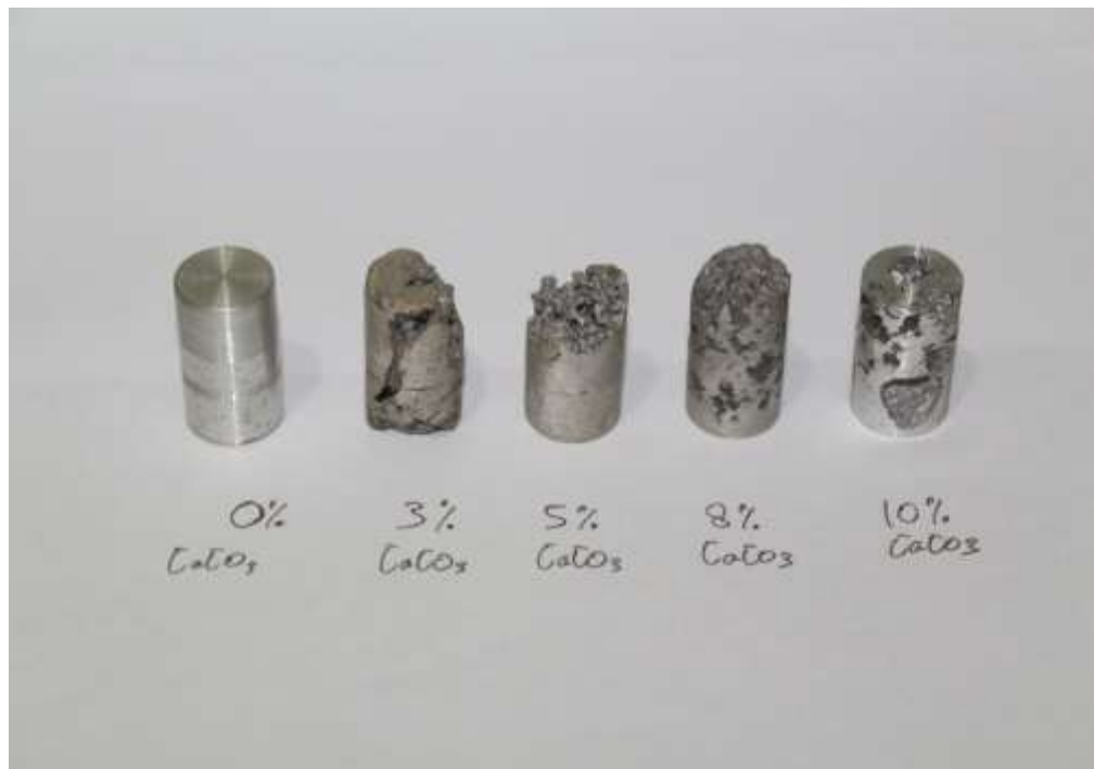
Gambar 4.2. Hasil Sampel Aluminum Foam dengan Variasi Fraksi Massa \text{CaCO}_3
