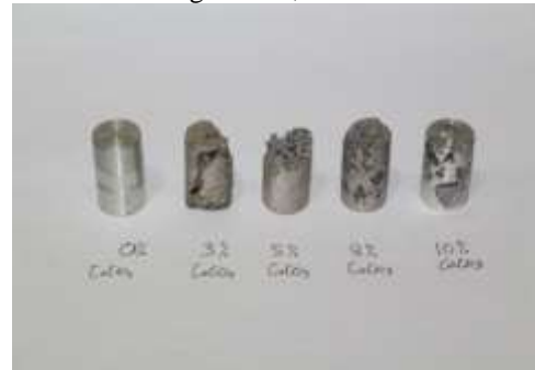
Gambar 4. Hasil Sampel Aluminium Foam dengan Variasi Fraksi Massa \text{CaCO}_3 Hasil Pengujian Struktur Mikro
