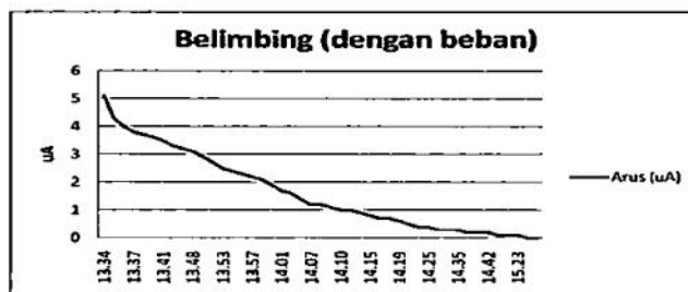
Gambar 4.19 Grafik arus satuan waktu 3 buah cell baterai terung (Zn dan Au)
