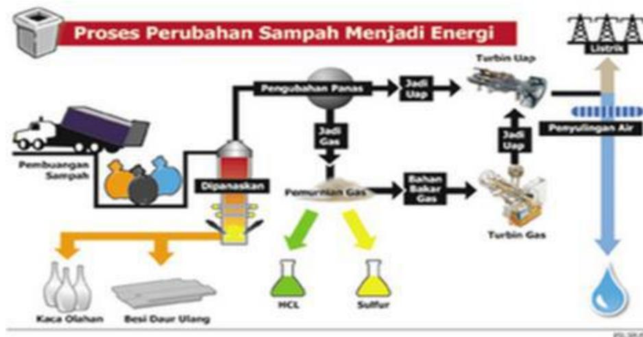
**Gambar 2.2** Proses Kerja PLTSa Thermal Dengan Gasifikasi
