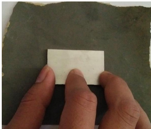
Gambar 3.31 Proses Pengamplasan Spesimen
