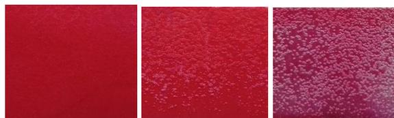
Gambar 4. Spesimen aluminium setelah proses *anodizing* dan *dyeing* setelah dilakukan pengujian visual dengan *adobe photoshop*, (a) arus 1 Ampere, (b) arus 2 Ampere dan (c) arus 3 Ampere. (TU) Titik Uji
