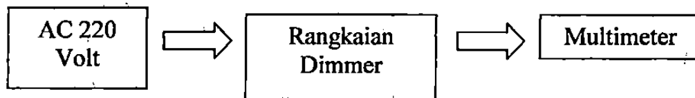
Gambar 4.7 Diagram Blok Pengujian Dimmer
