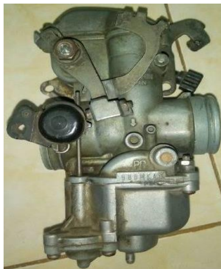
Gambar 3.4 Karburator standar dengan lubang venture 26 mm
