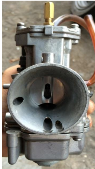
Gambar 3.5 Karburator PWK dengan ventury 28mm
