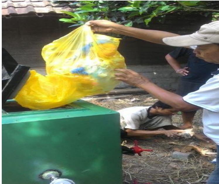
Gambar 3.9. Proses Pengisian Limbah Padat Rumah Sakit ke Incinerator
