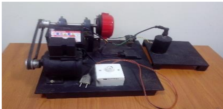
Gambar 3.7 Alat uji percikan bunga api pada busi
