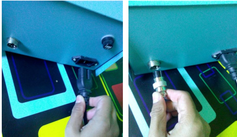
Gambar 3.11. Menghubungkan kabel power dan kabel sensor dan heater ke alat
