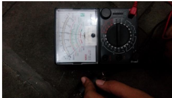
Gambar 3.11 Pemeriksaan kumparan sekunder koil ( Ignition Coil ) dengan cap busi
