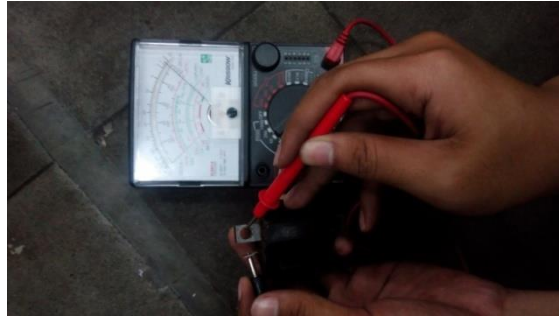
Gambar 3.9 Pemeriksaan kumparan primer Koil ( Ignition Coil )
