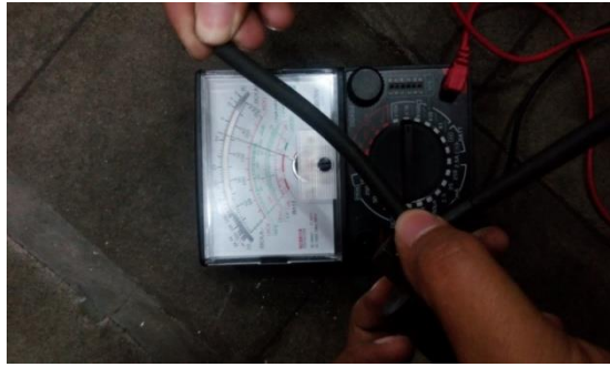
Gambar 3.10 Pemeriksaan kumparan sekunder koil ( Ignition Coil ) tanpa cap busi
