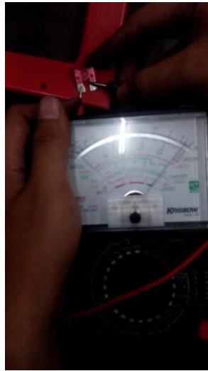
Gambar 3.6 Proses pemeriksaan sekering
