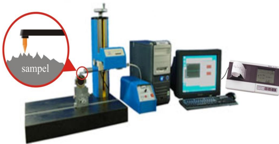
Gambar 2.8. Struktur stylus membaca permukaan sampel (hidayat, 2013)
