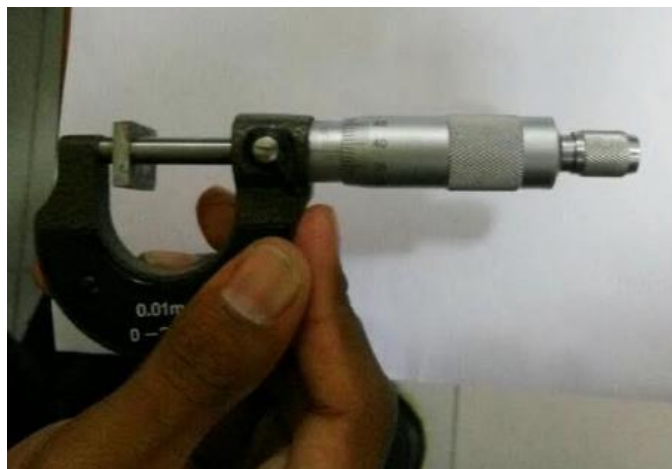
Gambar 3.27. proses pengujian tebal plat sampel
