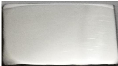
Gambar 3.6. stainless steel AISI-304 setelah pengampelasan
