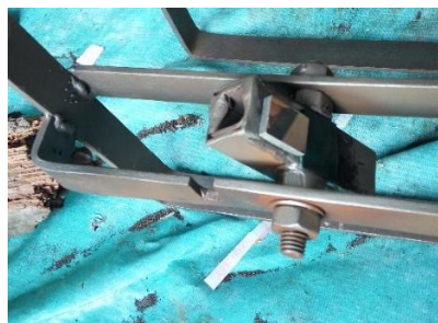
Gambar 3.16. bentuk pemegang sampel dengan variasi sudut
