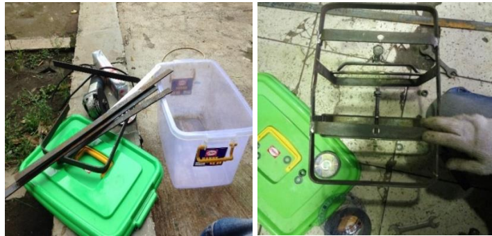
Gambar 3.15. proses pembuatan kerangka dan perakitan box shot peening
