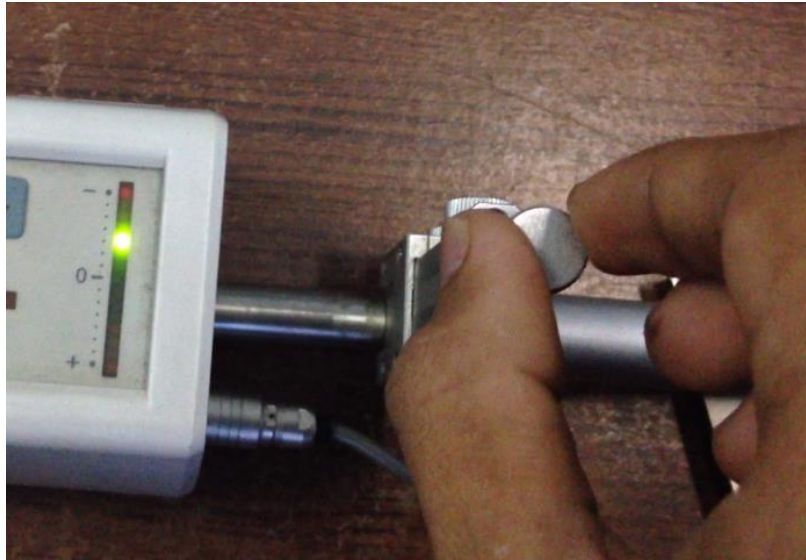
Gambar 3.23. Proses pemutaran Fine Adjust Knob
