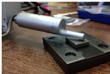
Gambar 3.25. Proses Pengujian Kekasaran permukaan pada sampel
